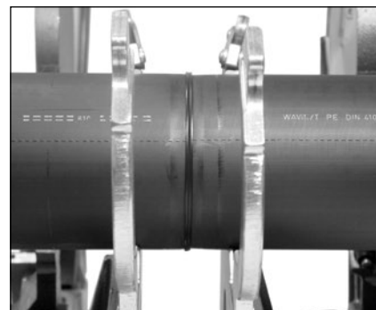
Správně vytvořený svarový spoj na tupo
