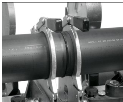
Chladnutí svařeného spoje
