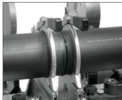
Chladnutí svařeného spoje
